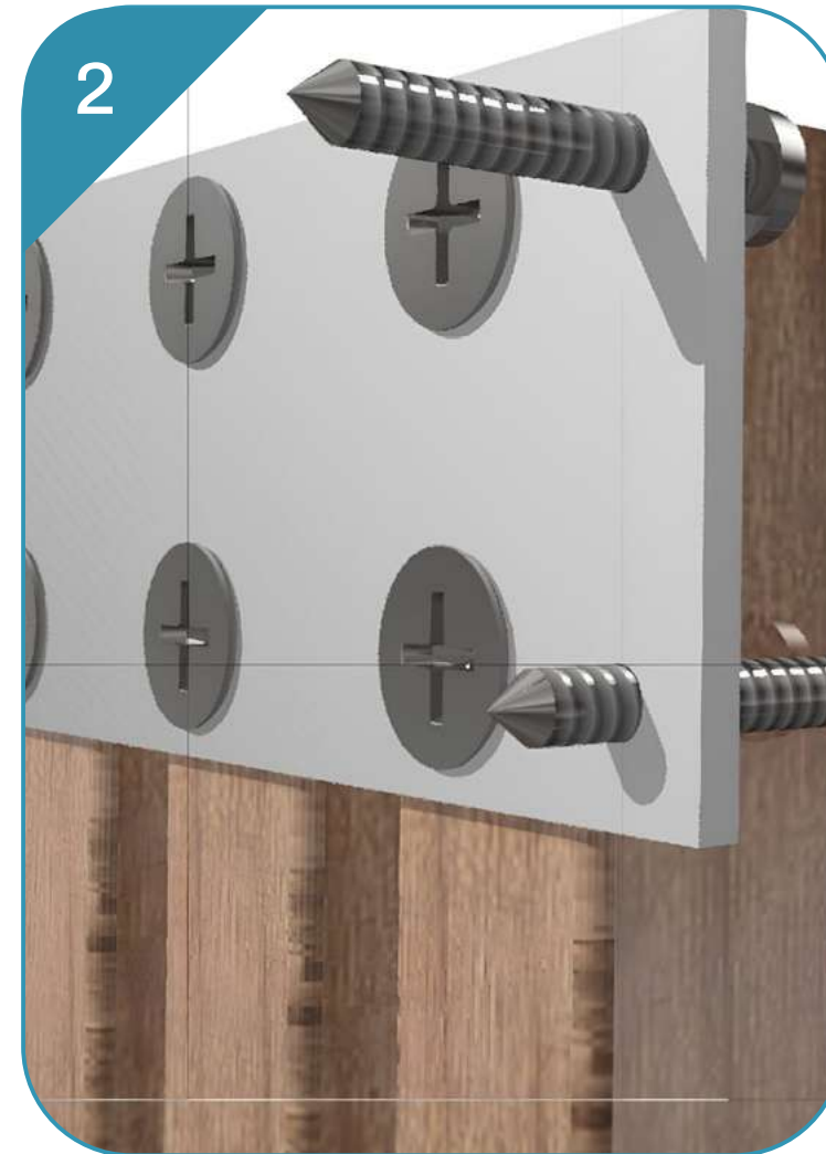
FIXAÇÃO EM BARRA CHATA METÁLICA
