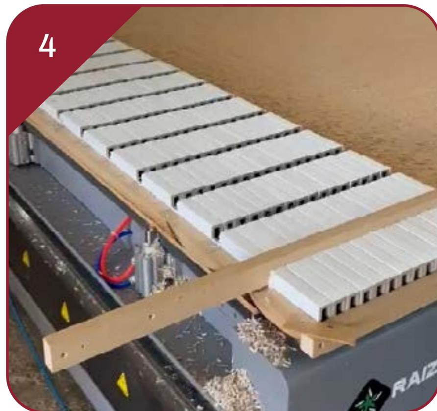
Para que o sistema de montagem do muxarabi fique perfeito, é realizado o processo de corte. Primeiro se define o espaçamento conforme a foto.
