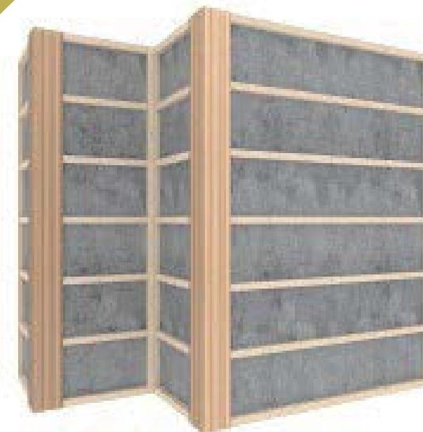
Parafusação de cada régua nos perfis e encaixe das mesmas em sequência, formando o painel ripado.
