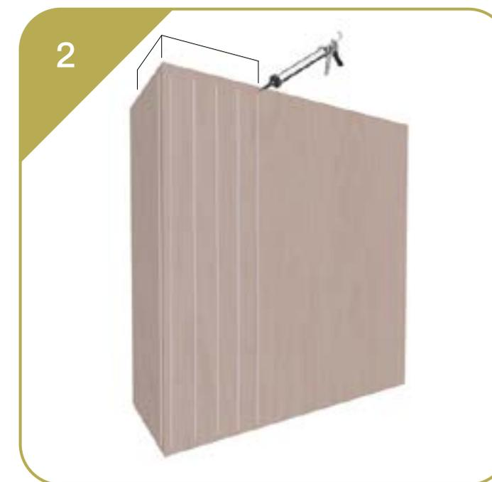
Realize a aplicação do adesivo estrutural na base de madeira para aplicação do painel conforme medidas previamente realizadas.
