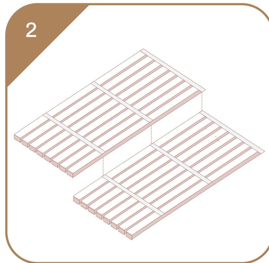
AJUSTE DA MODULAÇÃO DO MATERIAL DE ACORDO COM A FRENTE/ESPAÇAMENTO PLANEJADO E FIXAÇÃO DAS RÉGUAS EM BARRA CHATA METÁLICA COM PARAFUSOS AUTO ATARRAXANTES.
