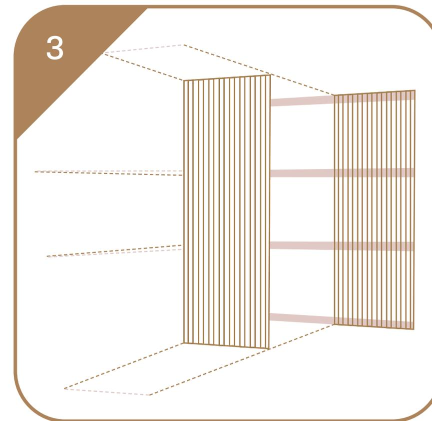
FIXAÇÃO DA BARRA CHATA NA ESTRUTURA METÁLICA COM PARAFUSOS AUTO BROCANENTES.
