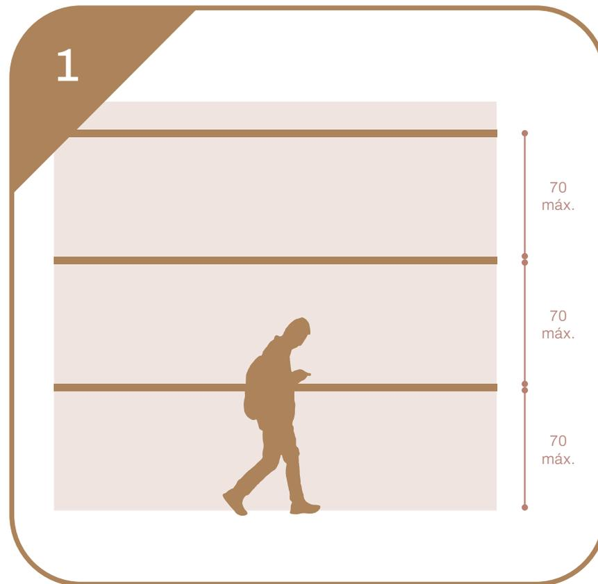
APLICAÇÃO DO PRODUTO TENDO EM CONTA UM DISTANCIAMENTO ENTRE APOIOS DE 70CM E FURO CONFORME AS MEDIDAS E APLICAÇÃO DAS BUCHAS SEGUNDO A SUPERFÍCIE DE INSTALAÇÃO.
