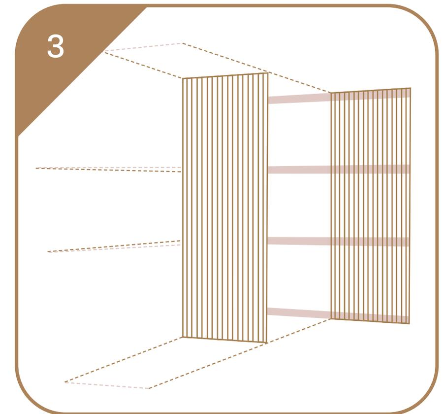
FIXAÇÃO DA BARRA CHATA NA ESTRUTURA METÁLICA COM PARAFUSOS AUTO BROCANES.
