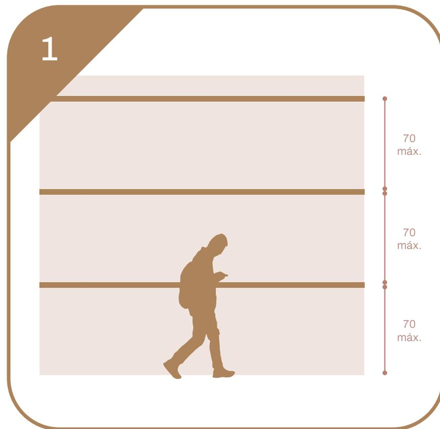
APLICAÇÃO DO PRODUTO TENDO EM CONTA UM DISTANCIAMENTO ENTRE APOIOS DE 70CM E FURO CONFORME AS MEDIDAS E APLICAÇÃO DAS BUCHAS SEGUNDO A SUPERFÍCIE DE INSTALAÇÃO.
