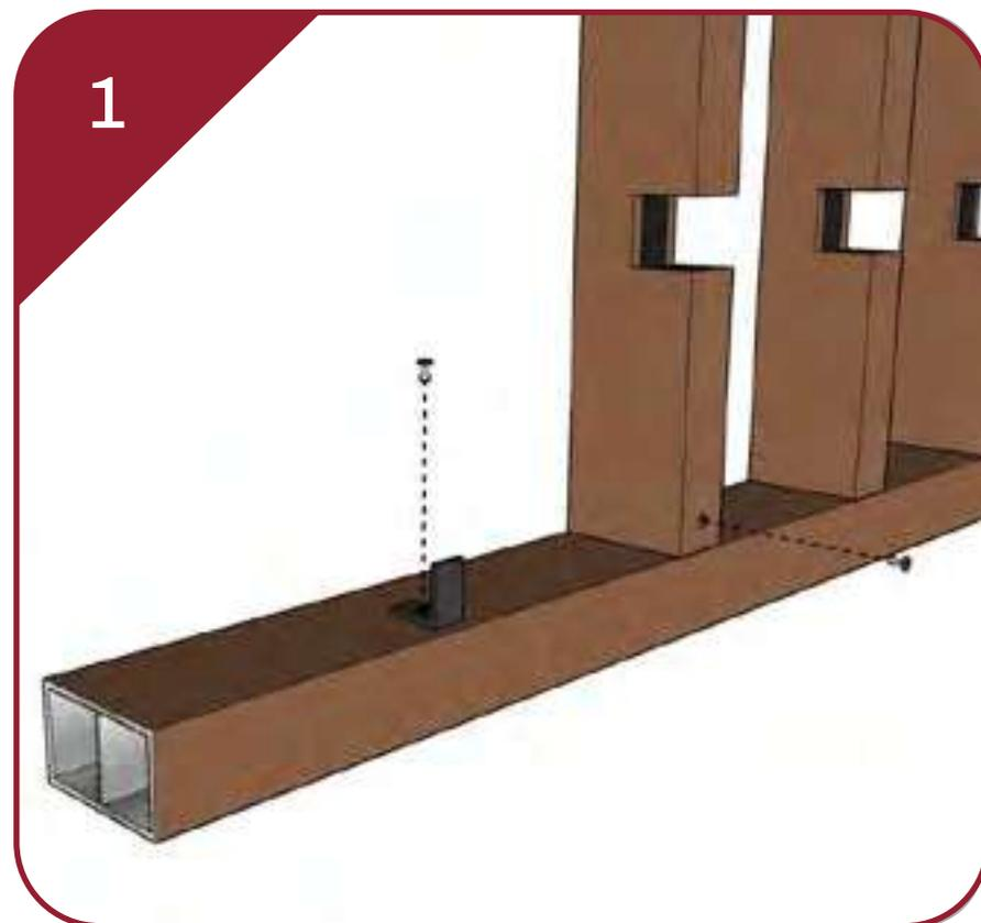
Inicie parafusando as cantoneiras de fixação na barra perimetral revestida de alumínio já cortada no tamanho desejado.
