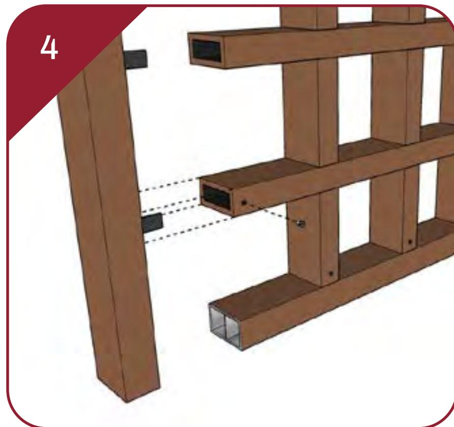
Os perfis de alumínio formam o sistema perimetral de fixação dos perfis internos no quadro. Parafuse as cantoneiras no perfil metálico e em seguida nos perfis internos.
