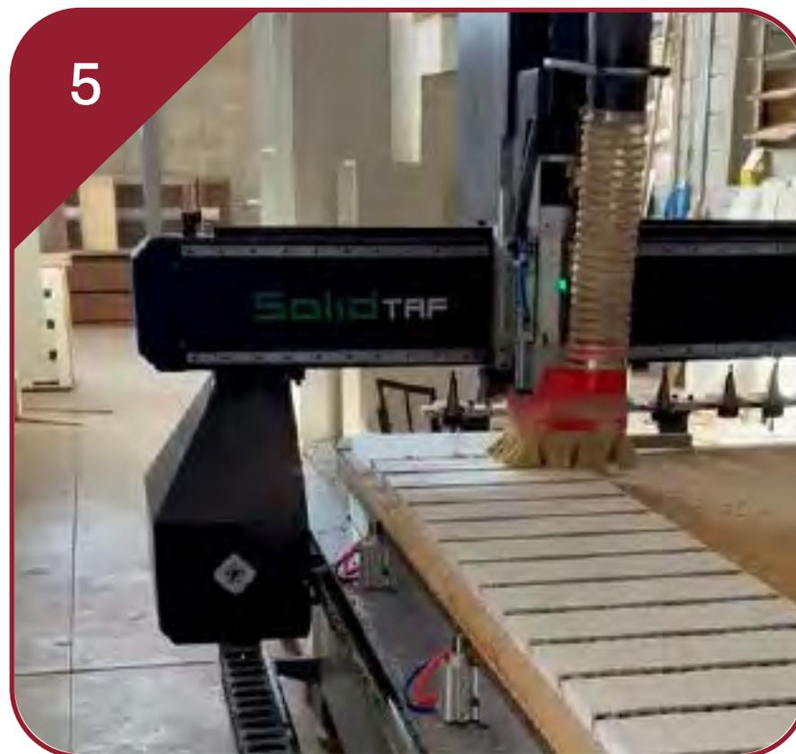
Em seguida, na máquina CNC, é realizado o corte conforme foi definido previamente, assegurando-se de um bom acabamento na montagem.
