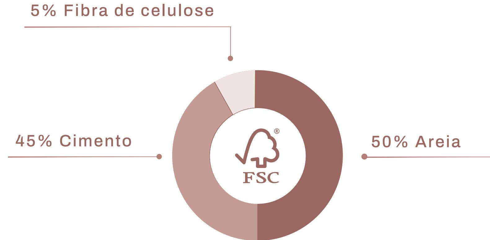
Painéis de fibrocimento de alta densidade e grande flexibilidade de design. Por serem coloridos em massa, possibilitam destaque para textura e cor aplicada. Trata-se de um material com grande resistência a fatores externos.
