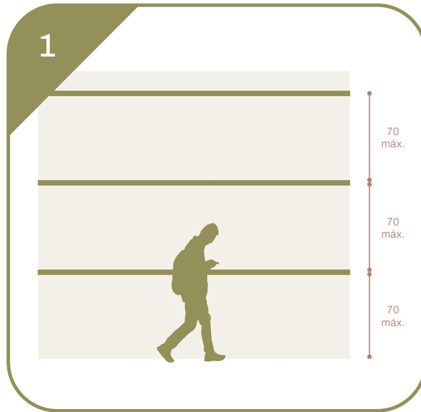
1 APLICAÇÃO DO PRODUTO TENDO EM CONTA UM DISTANCIAMENTO ENTRE APOIOS DE 70CM E FURO CONFORME AS MEDIDAS E APLICAÇÃO DAS BUCHAS SEGUNDO A SUPERFÍCIE DE INSTALAÇÃO.
