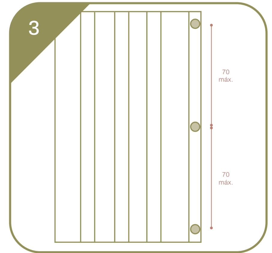
3 PARAFUSAÇÃO DE CADA RÉGUA NOS PERFIS E ENCAIXE DAS MESMAS EM SEQUÊNCIA, FORMANDO O PAINEL RIPADO.
