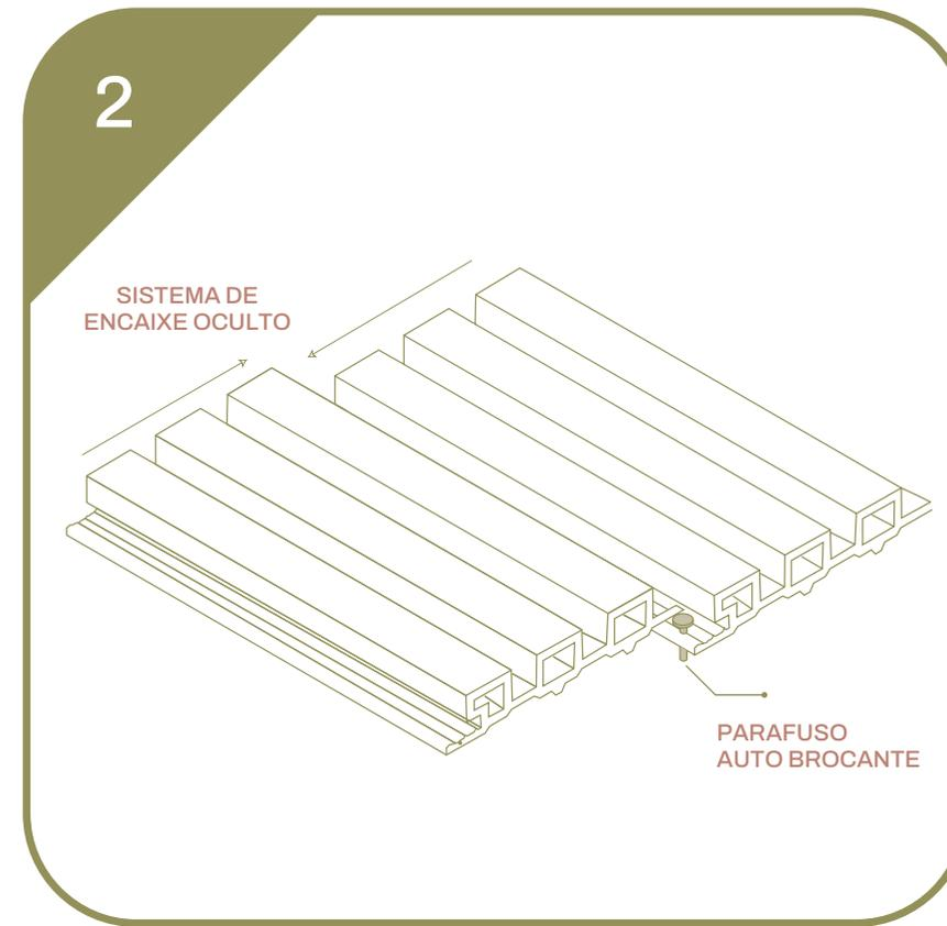
2 PARAFUSAÇÃO DAS CANTONEIRAS COM PARAFUSO AUTO BROCANTE E INSTALAÇÃO DOS PERFIS SOBRE AS MESMAS, ASSEGURANDO-SE DE QUE ESTÃO NIVELADAS.
