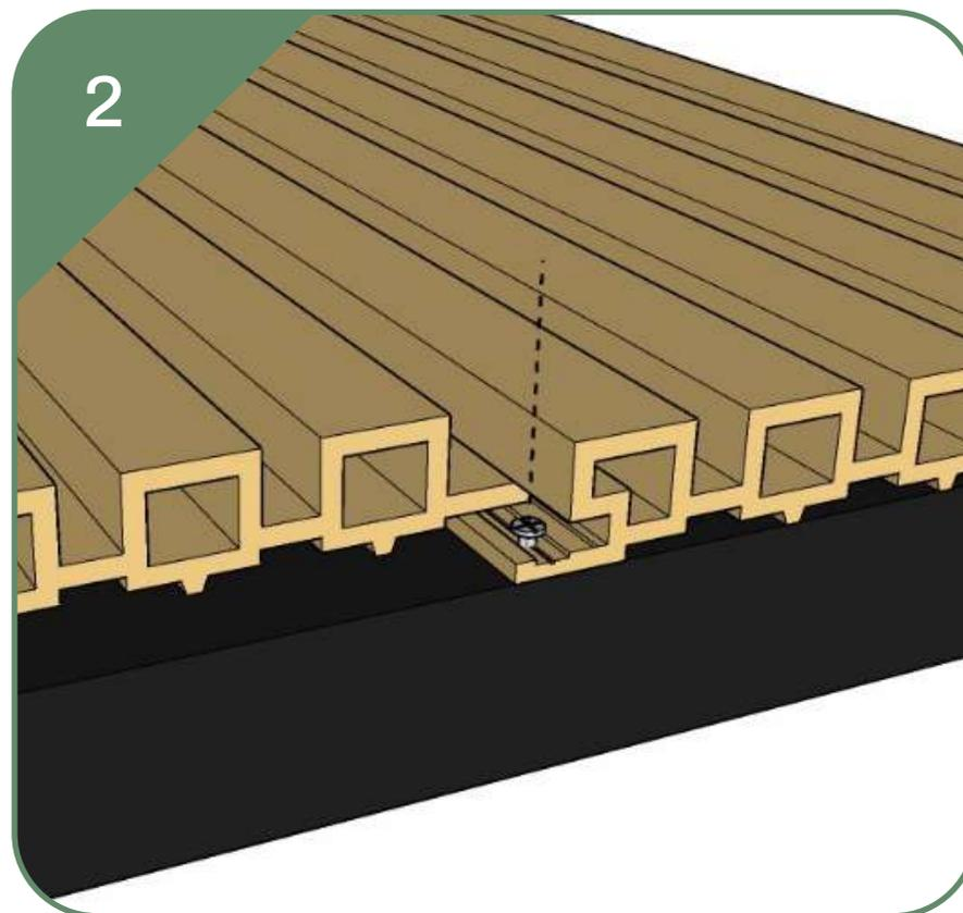
Assegurando-se das medidas, parafuse com parafuso auto brocante o primeiro perfil ripado no perfil tubo metálico já fixado na superfície de instalação.
