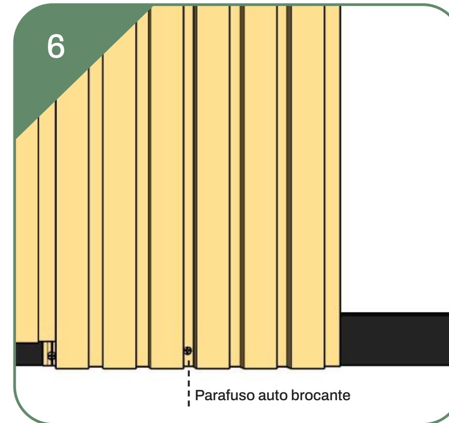
Utilize parafusos auto brocantes para instalar os perfis do Arkwood EP nas estruturas metálicas fixadas na superfície.
