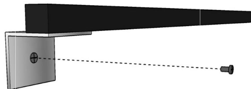
Parafuse as cantoneiras nos furos previamente realizados na superfície. Em seguida, fixe o perfil de tubo metálico nas cantoneiras instaladas para sustentação.
